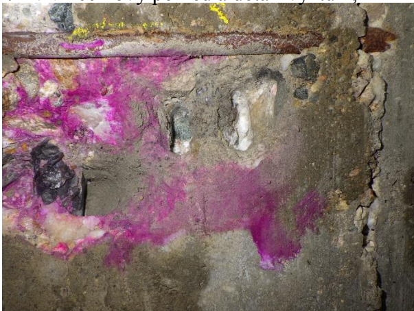
Foto č. 106-109 – sonda NV10 rámu RI.- uvnitř 1.NP-celkové pohledy a detail výztuže,
